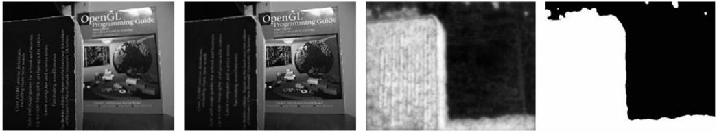
(a) 从左至右依次为: book组图聚焦前景, 聚焦背景, 深度图, 模版图
